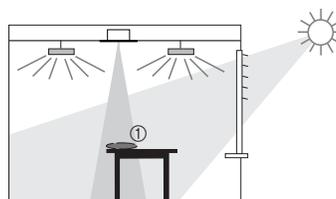
$$\text{Fator de correção do espaço} = \frac{\text{Valor de luminosidade no teto}}{\text{Valor de luminosidade na superfície de trabalho}}$$
